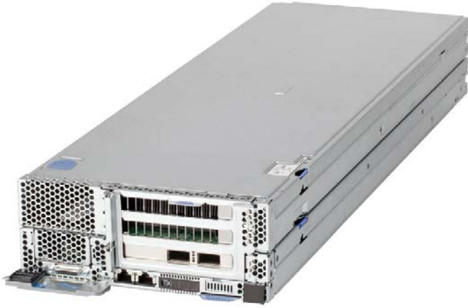
Nœud Lenovo NeXtScale System nx360 M5 avec unité d'extension native PCI
